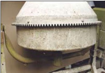
Das aus Blech geformte Kegelrad ist ein derartiges Beispiel – Bild 1.
